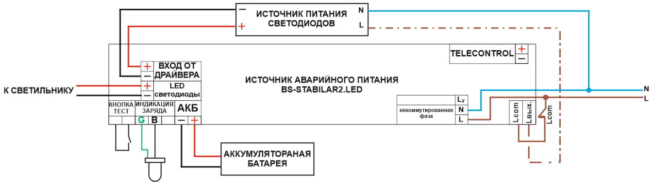
Рис. 2 Схема подключения BS-STABILAR2-81-B4-LED и BS-STABILAR2-83-B4-LED для аварийного светового прибора в непостоянном режиме:
