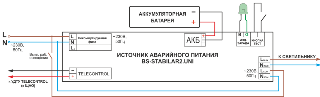
Рис. 2 Схема подключения BS-STABILAR2-81-B1-UNI (1,0-15 W / = 190-260 V) для аварийного светового прибора в непостоянном режиме:
