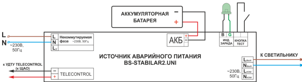
Рис. 2 Схема подключения BS-STABILAR2-81-B2-UNI для аварийного светового прибора в непостоянном режиме:
