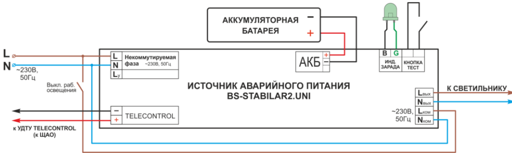
Рис. 2 Схема подключения BS-STABILAR2-81-B2-UNI для аварийного светового прибора в непостоянном режиме:
