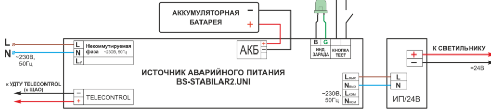
Рис. 2 Схема подключения BS-STABILAR2-81-B5-UNI для аварийного светового прибора в непостоянном режиме
