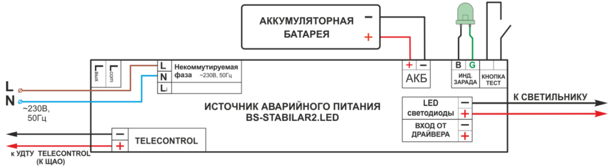
Рис. 2 Схема подключения BS-STABILAR-81-B3-LED и BS-STABILAR-83-B3-LED для аварийного светового прибора в непостоянном режиме:
