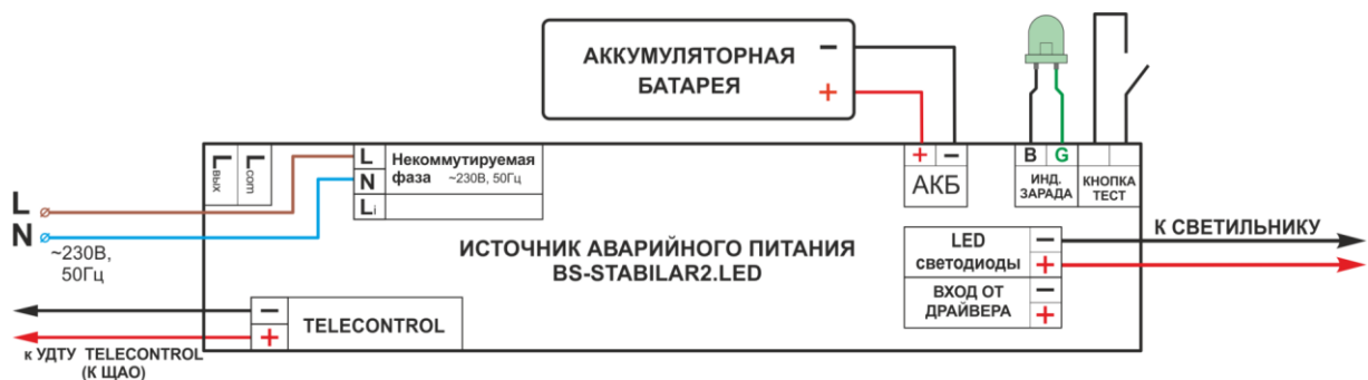
Рис. 2 Схема подключения BS-STABILAR2-83-B2-LED для аварийного светового прибора в непостоянном режиме:
