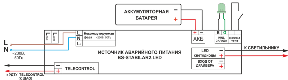
Рис. 2 Схема подключения BS-STABILAR2-81-B1-LED для аварийного светового прибора в непостоянном режиме:
