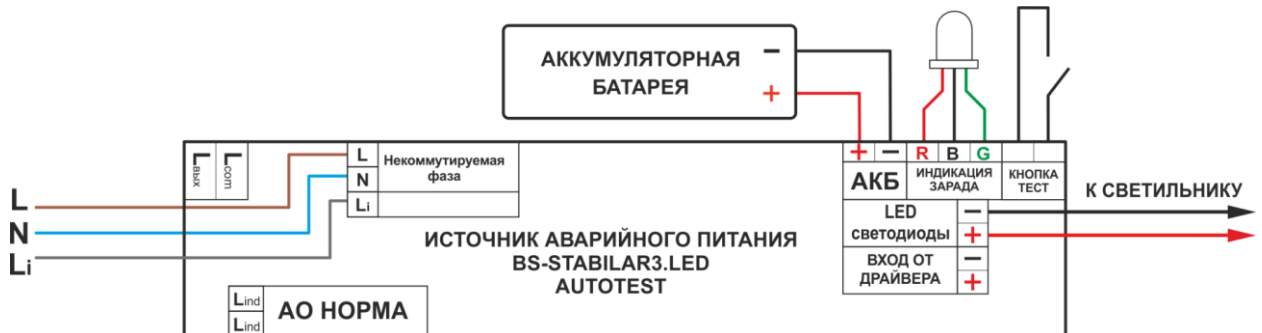
Рис. 2 Схема подключения BS-STABILAR3-81-B2-LED и BS-STABILAR3-83-B2-LED для аварийного светового прибора в непостоянном режиме:
