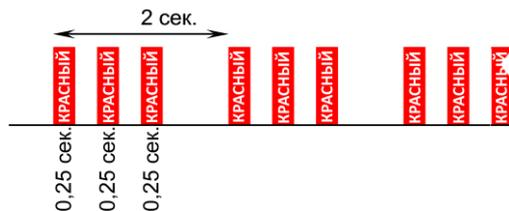
Функция автотестирования контролирует процесс заряда аккумуляторной батареи. В случае уменьшения тока заряда более чем на 30%, признаётся, что аккумуляторная батарея или её зарядное устройство неисправны. Светодиодный индикатор светового прибора быстро мигает красным (2 раза в 1 секунду) показывая неисправность заряда. Если световой прибор подключен к ЩАО BS-АКТЕОН-2, то групповой индикатор «АО НОРМА» в ЩАО BS-АКТЕОН-2 гаснет до устранения неисправности.
