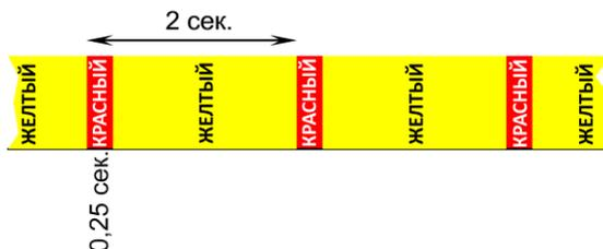
Если по окончании заряда напряжение на аккумуляторной батарее остаётся ниже 1В на элемент, то признаётся, что батарея неисправна. Зарядное устройство сохраняет пониженный ток заряда. Светодиодный индикатор светового прибора горит зелёным, но периодически через 2 секунды мигает красным по 0,25 секунды, показывая низкое напряжение батареи. Если световой прибор подключен к ЩАО BS-АКТЕОН-2, то групповой индикатор «АО НОРМА» в ЩАО BS-АКТЕОН-2 гаснет до устранения неисправности.
